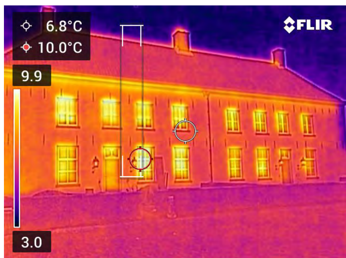
Voorgevel - warmteverliezen bij de gevelopeningen, schoorstenen en onder de goot van de Commandeurswoning zichtbaar
