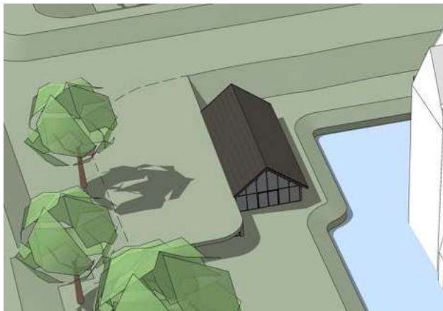
gras van de vestingwal loopt door over het dak
